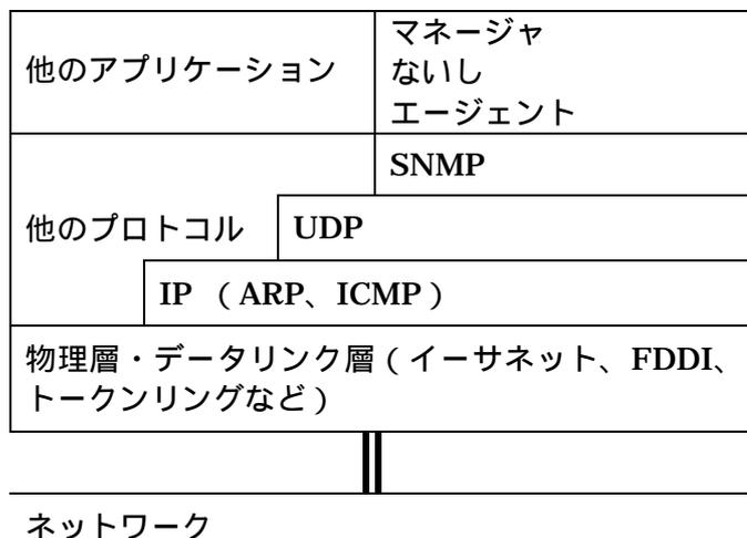
図 6 - 7 SNMP 管理を実施する FA 機器の一般的なプロトコルスタック
