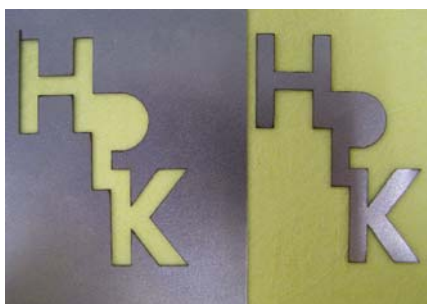
図 4. 6. 2. 2 ファイバディスクレーザーによる切断加工の一例
