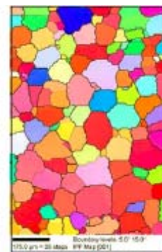
図4. 4. 2 Al-3Mg 合金結晶方位分布の一例
