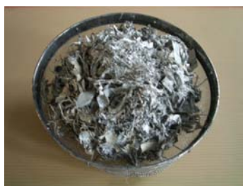
図3. 15 剥離した熱線プリント（酸溶液の浸漬時間 30 分）
