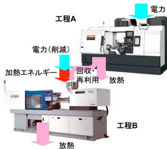
図5. 5. 2 加工工程間の排熱再利用
