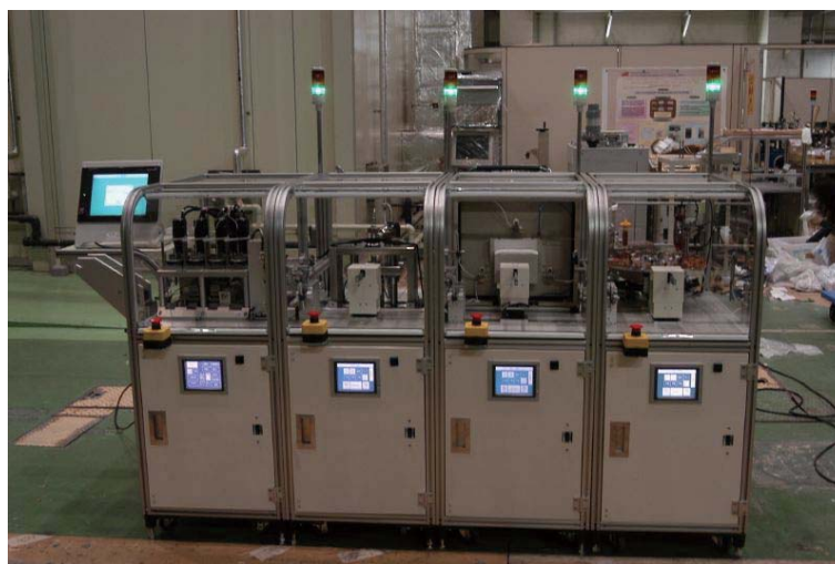
図 3.6: 金属ベース光スキャナーデバイスを作成するために試作された、on-demand 製造システム。共通のフレームで構成された4つのユニットからなり、左からプレス装置、AD 成膜装置、熱処理装置、配線装置である
