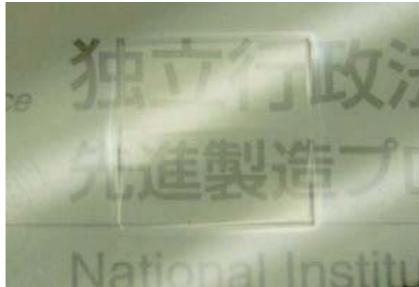
図 2.11: ガラス基板上的 AD 法によるあるアルミナ膜、ガラス基板の下の文字が透けて見えることから透明であることがわかる。
