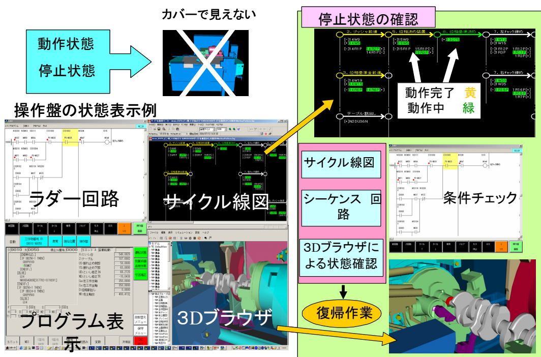
図2.4-19 機械の動作状態の3Dシミュレーションによる視覚化
