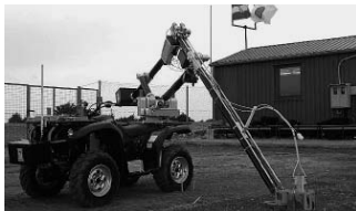
写真1: クロアチアでの地雷探査ロボット実証実験(東工大)
