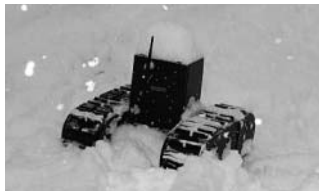
写真2: 新雪上でのクローラロボット走行試験の様子
