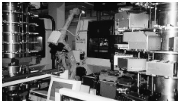
MCとロボット、ATCを組み合わせたセル
